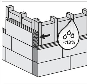
L'humidité du matériau peut être mesurée avec un humidimètre pour bois Gann BL H41. Si l'on ne dispose pas d'un tel outil, on peut coller hermétiquement un film de polyéthylène d'environ 70 cm sur 70 cm sur les panneaux STEICO support d'enduit. Si au bout de 24 h il y a condensation de vapeur d'eau, les panneaux ne peuvent pas être enduits.
