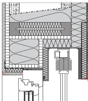
La surcôte d'isolant (épaisseur min. 40 mm) sera collée au coffre de volet et à l'ITE avec du STEICOmultiphase.
