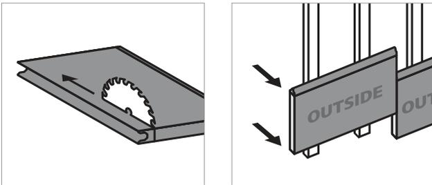
Le premier panneau de la rangée ainsi que le dernier doivent être dépourvus de rainure et languette du côté de l'angle de la façade pour assurer une pose à bords droits.
